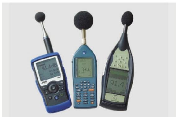
50 Sonomètres intégrateurs de précision avec analyse spectrale et enregistrement sonore
