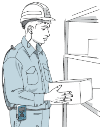
Figure 26 Dosimètre – Position à la ceinture du dosimètre avec câble
