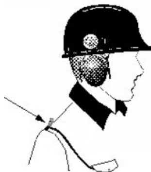
Figure 25 Dosimètre – Position du microphone selon CSA et ISO : dosimètre avec câble et sans fil
