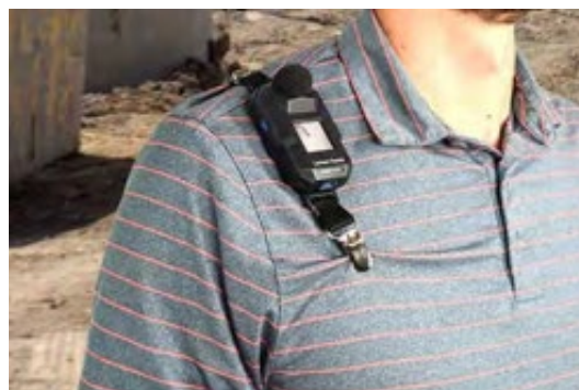
Figure 25 Dosimètre – Position du microphone selon CSA et ISO : dosimètre avec câble et sans fil
