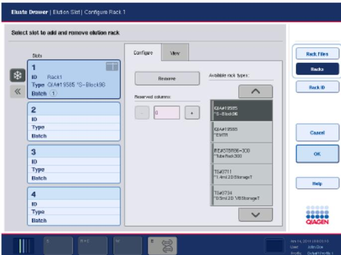
10. Fermer le tiroir. L'écran
