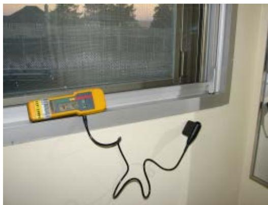
Mesure de la moiteur sous une fenêtre où une infiltration d'eau est soupçonnée.
