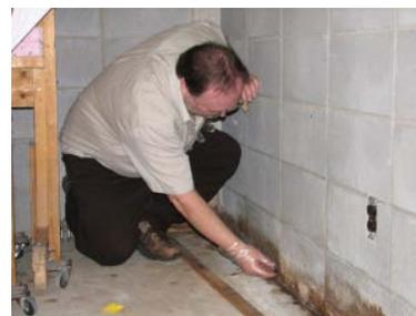
Prélèvement d'un échantillon de surface à l'aide d'une lame autocollante.
