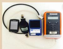
UFP/PM<sub>0.1</sub>: Classificateur miniature de taille par diffusion (miniDISC, Windisch, Suisse), BC: MicroAeth Model AE51 aéthalomètre (Magee Scientific, Berkeley, Etats-Unis), Bruit: Dosimètre de bruit (Bruel & Kjaer, Naerum, Danemark), PM<sub>2.5</sub>, O<sub>3</sub>, NO<sub>2</sub>: Moniteurs fixes, moniteurs d'aérosol, Université de Toronto
