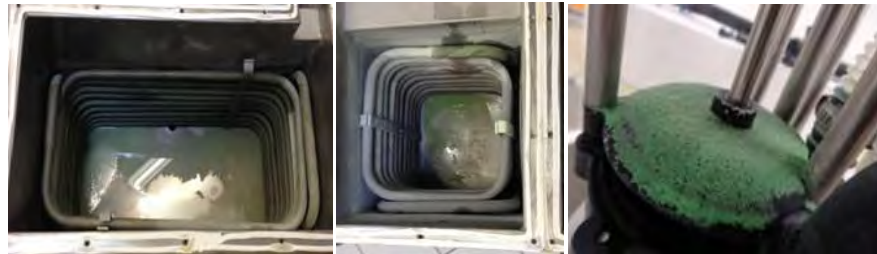
Figure 2 Présence de biofilm dans le réservoir
