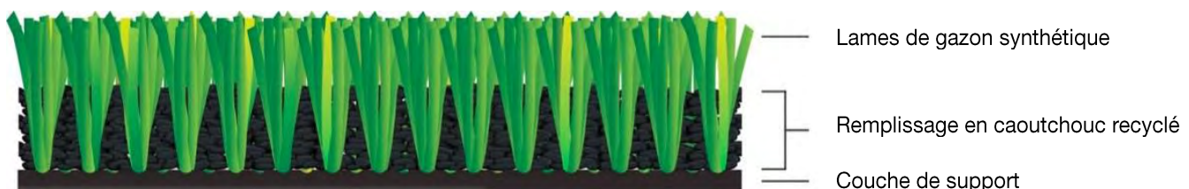
Figure 1 Composition typique d'une surface en gazon synthétique
