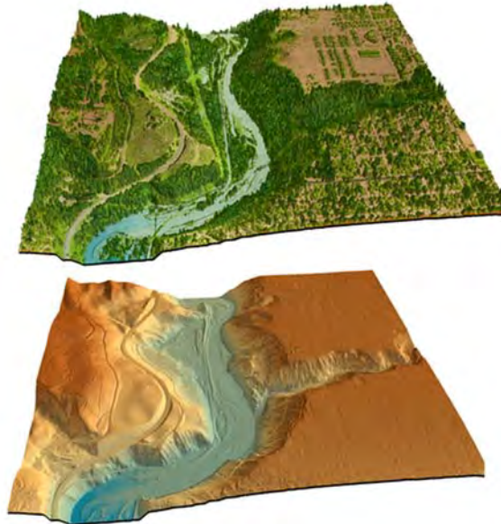
Figure 3b Exemple de modélisation de zones inondées grâce aux données LiDAR implémentées dans ArcGIS et le logiciel complémentaire HEC-GEORAS 3
