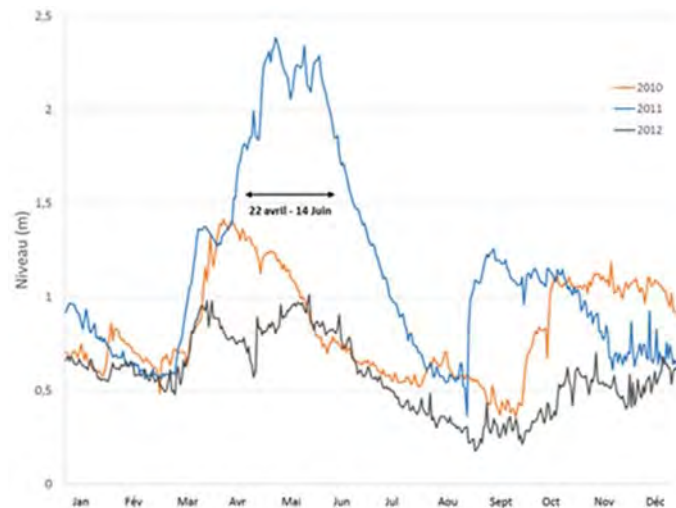
Figure 2 Niveau d'eau de la rivière Richelieu enregistré à la station 02OJ016 située à la marina de Saint-Jean-sur-Richelieu en 2010 (orange), 2011 (bleu) et 2012 (gris)
